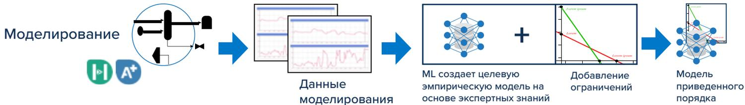
Рисунок 2: Схема гибридной модели приведенного порядка. Инженеры-технологи используют настроенные имитационные модели для создания моделей приведенного порядка на базе машинного обучения, которые можно последовательно развернуть в ряде целевых приложений.
